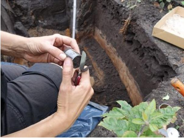
Entnahme ungestörter Bodenproben mit Kunststoffzylindern. Bild: Susanne Döhler (UFZ)
